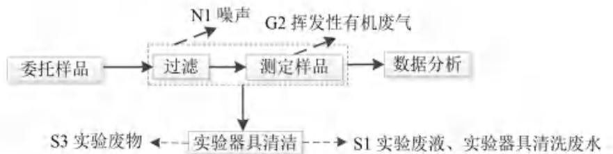
图 6 水中铀检测流程及产污环节图
